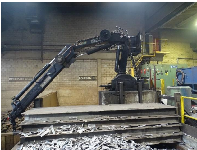
hydraulischer, baggerähnlicher Kran mit Magnet
