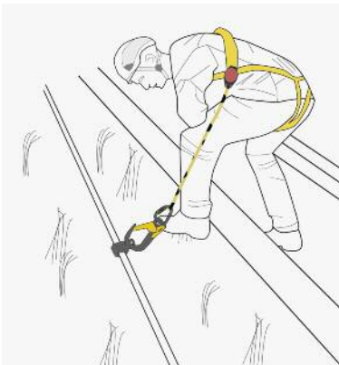
Bild 50: Fest installiertes horizontales Sicherungssystem
