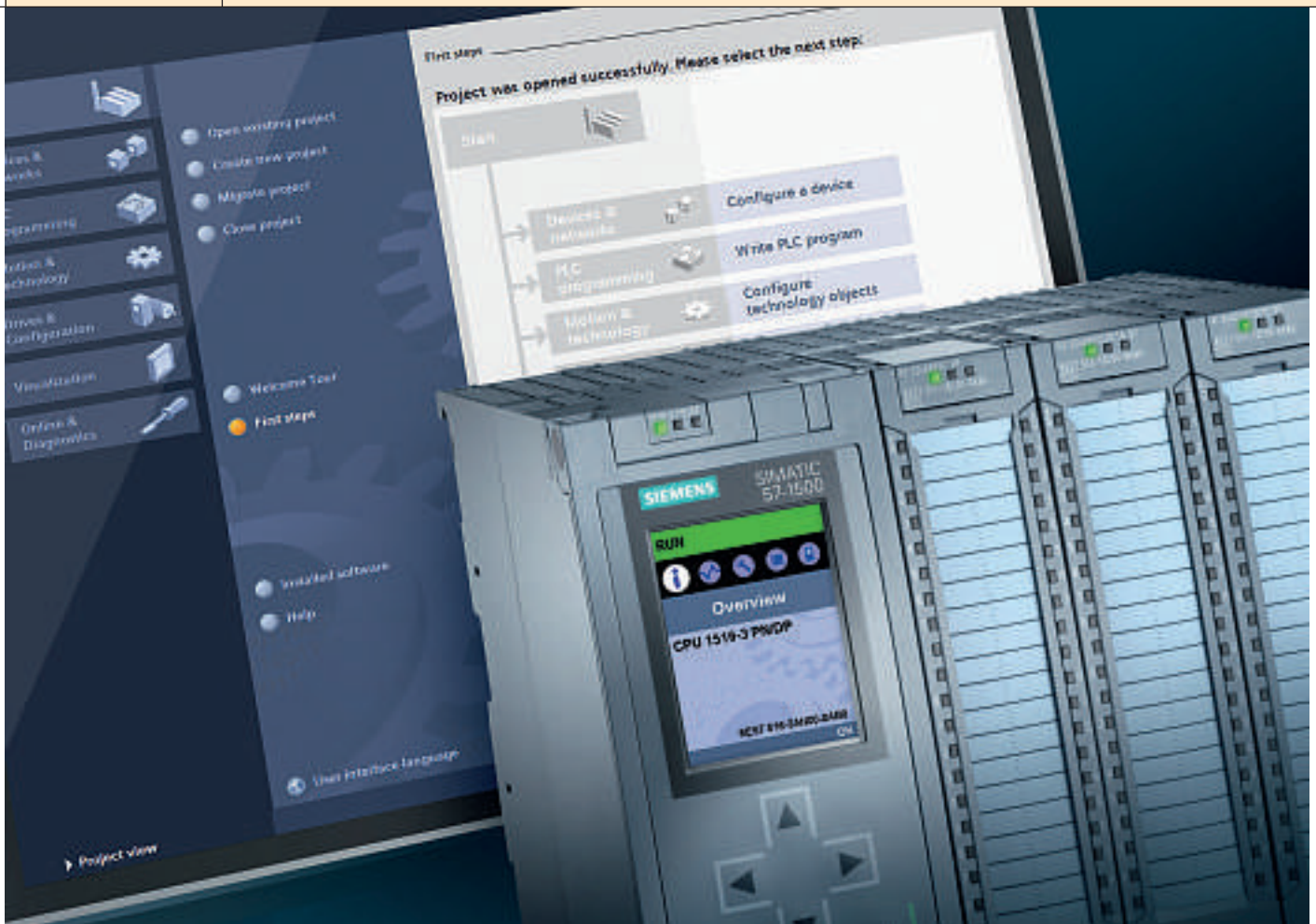
Die Simatic 57-1200 eignet sich für Applikationen im unteren Leistungsbereich, die 57-1500 für mittlere und High-End-Anwendungen
