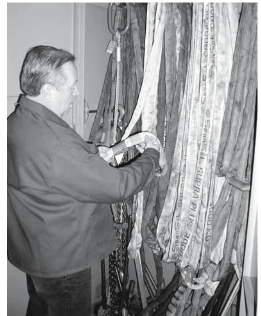
Bild 5: Kontrolle der Anschlagmittel durch eine Person, welche die erforderlichen Kenntnisse besitzt.
