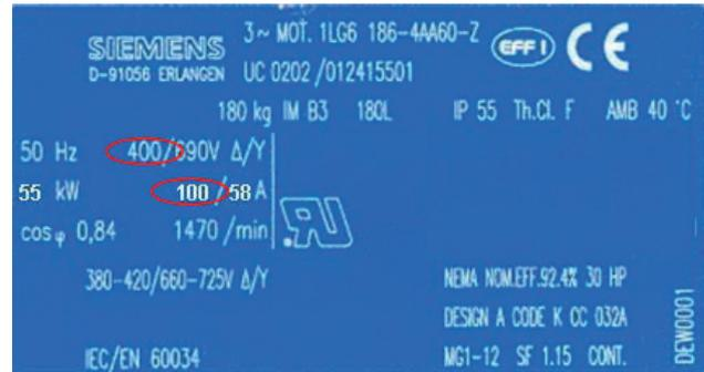
Am Potentiometer  $I_e$  muss der Bemessungsbetriebsstrom des Motors entsprechend der vorliegenden Netzspannung bzw. der Motorverschaltung (Stern/Dreieck) eingestellt werden. Auf diesen eingestellten Wert bezieht sich auch der elektronische Motorüberlastschutz, wenn er aktiviert ist. Zulässige Einstellwerte bezogen auf die gewünschte Motor-Überlastauslöseklasse, siehe Kapitel Motorstromeinstellwerte (Seite 115).
