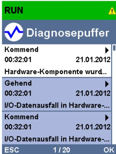
Bild 4-6 Display Diagnosepuffer
