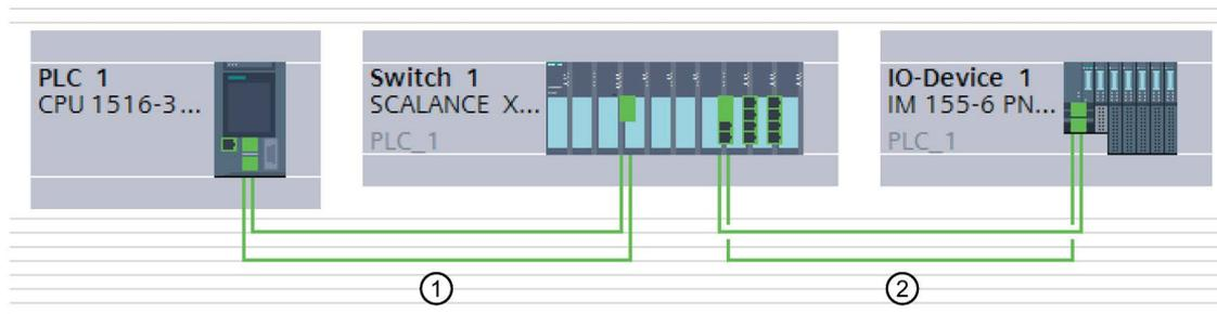
Bild 5-40 Beispielkonfiguration mit zwei Ringen ① und ②
