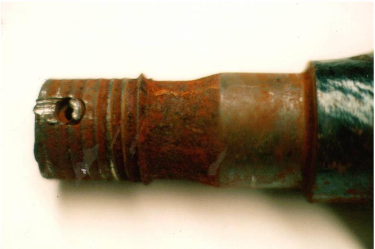
**Bild 1: Korrosion des Gewindes am Hakenschaft**
