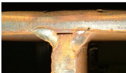
Abb. 6: Ausführung der oberen Halsnaht beim I-Schweißprofil: a) und c) mit Kehlnähten, ohne Druckkontakt (schlecht); b) mit K-Naht (empfehlenswert)
