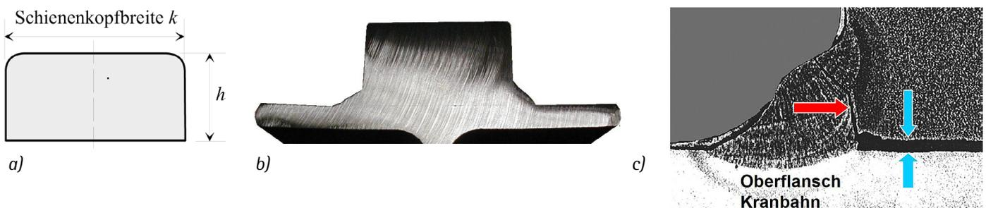
Abb.10: Flachstahlschiene (a); ...aufgeschweißt auf ein Walzprofil (b; Foto: Alfred Klöckner); Riss in einer fehlerhaft berechneten und ausgeführten Schienenkehlnaht (c)
