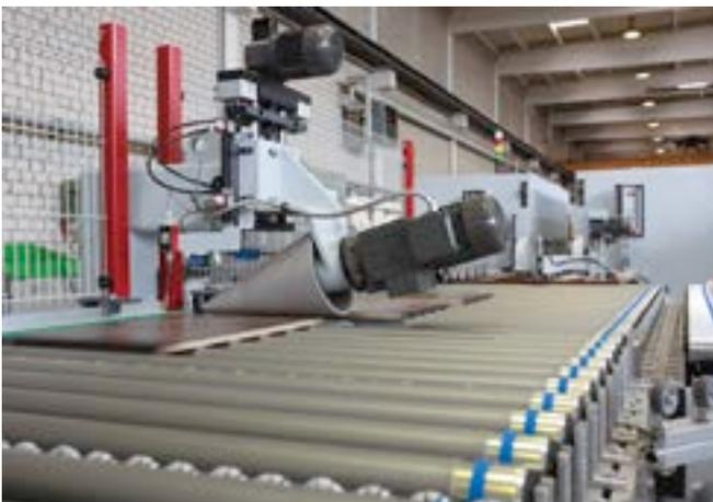
Die Heinrich Kuper GmbH & Co. KG, weltweit agierendes Unternehmen der Holz- und Kunststoffbearbeitung, ist Spezialist für das Retrofit älterer Maschinen. Neue Automatisierungs- und Sicherheitstechnik mit fehlersicherem Software-Controller auf einem wartungsfreien Embedded PC vervielfachte die Performance und Präzision einer Kundenanlage und integrierte die Diagnosefähigkeit. Reduziert wurden die Schaltschrankgröße um 20 Prozent, die Verdrahtung um 50 Prozent und die Maschinenstillstandzeiten.
